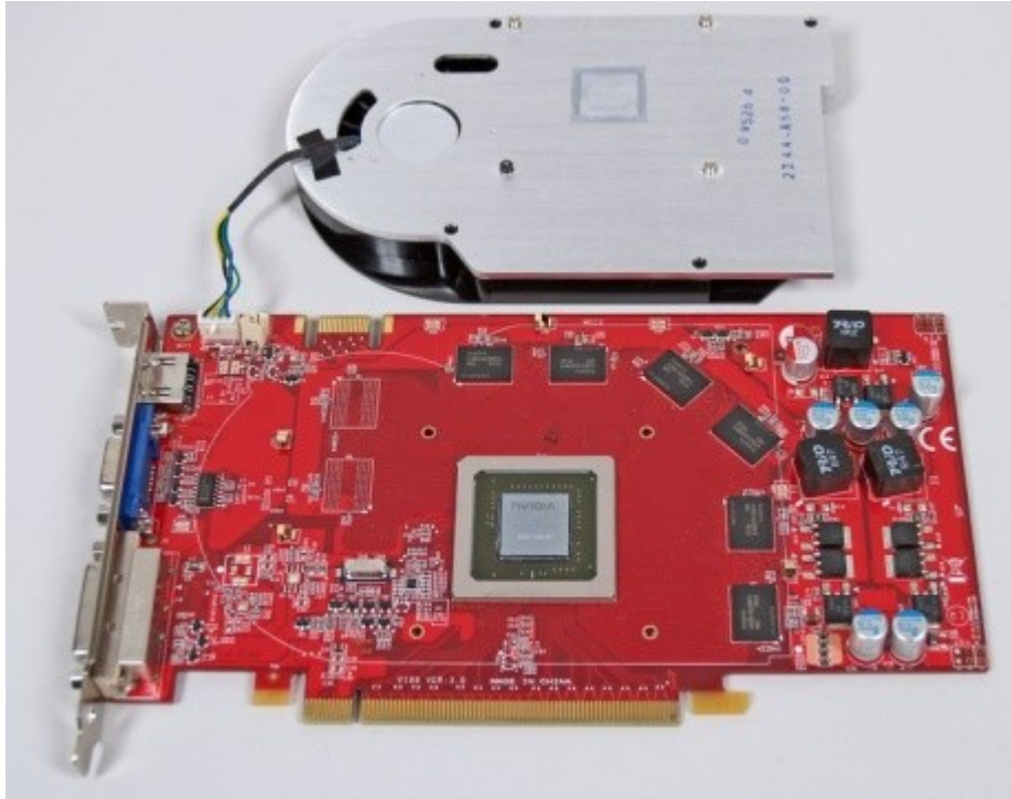
Aufgedeckt: Nvidia Geforce GT 330 mit demontiertem Kühlkörper
